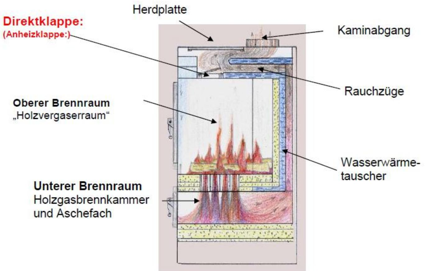
Die Bedienung des Walltherm ist einfach. Vor dem Anheizen des Ofens muss die Anheizklappe geöffnet werden, damit der Rauch nach oben direkt in den Kamin austritt.
