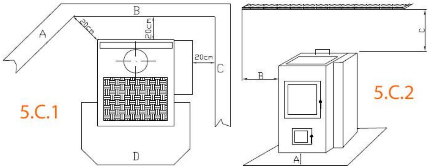
Hierbei sind jeweils die Landesgesetze/Normen gültig! In der Abbildung (Abb. 5.c.1) sind die Mindestabstände zu brennbaren Materialien/Wänden (z. B. Tapete, Holzwand) angegeben, die bei der Aufstellung des Walltherm einzuhalten sind.
